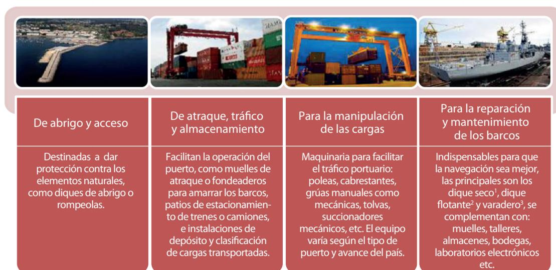
1 Dique seco, cuna en forma de casco de barco, situada bajo el nivel de las aguas y provisto de una puerta que los cierra o abre y un sistema de bombas que permite el llenado o vaciado del dique.
